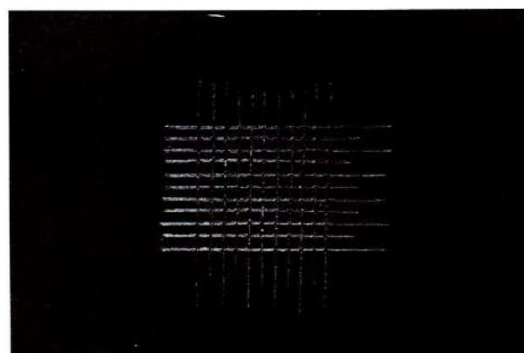
Primeiro teste de aderência realizado no CP 2. Classificação 5B (0 % de destacamento).
